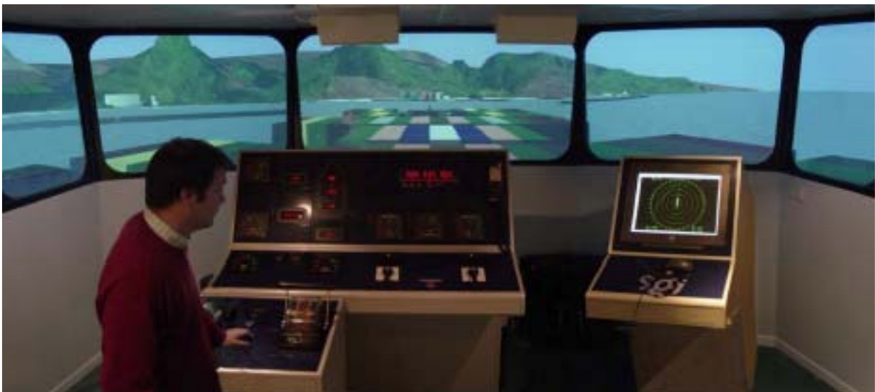
Figura 7. Simulador de maniobra de buques en tiempo real (Siport XXI)
