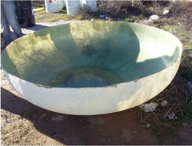
Figura 11: Sección de torisférico superior de PRFV
