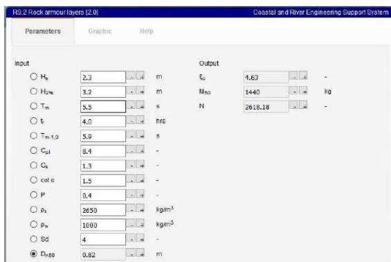
Fig. N° 9: Salida del programa para el escenario Hs = 2.3m y Tm = 5.5seg. Se obtiene de este cálculo una piedra de peso W = 1440Kg, correspondiéndole al morro un peso 50% mayor:
