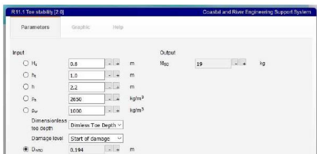
Fig. N° 12: Salida del programa para H_s = 0,8\text{m} y nivel de agua -2,27\text{m} bajo cero Riachuelo
